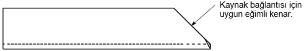
90° Aşamalı Açıyla Basit Kıvrımlı Flanş
