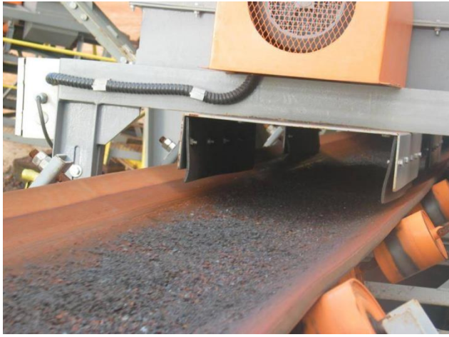
Şekil 3.4. Sinter harmanının sinter fırınına ilerlemesi ve yanma bölgesi
