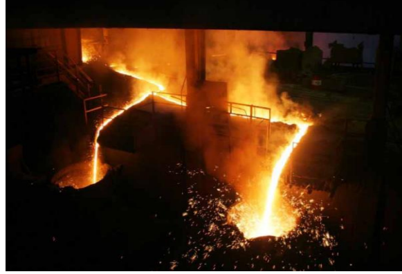
Şekil 5.8. Sıcak metal ve curuf alımları
