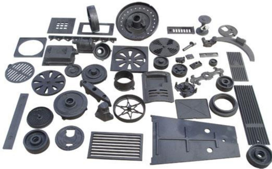
Şekil 11.4. Küresel grafitli dökme demirden üretilmiş bazı malzemeler
