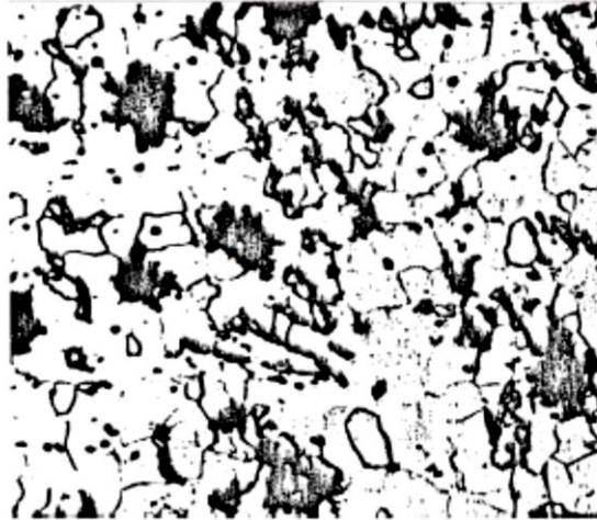
Şekil 11.6. Temper dökme demirin mikroyapısı
