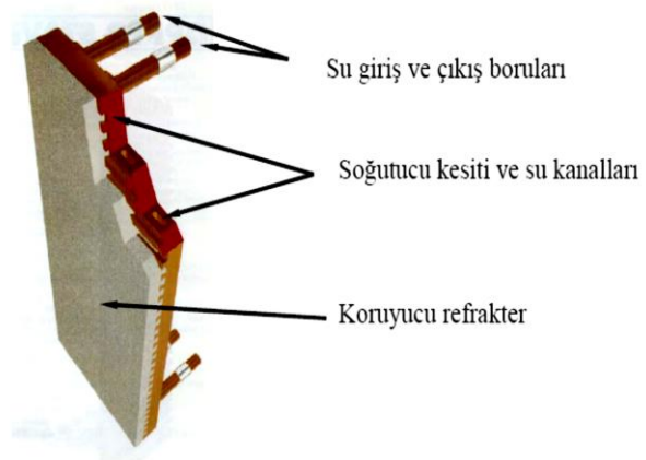
Şekil 5.12. Panel tipi soğutucu
