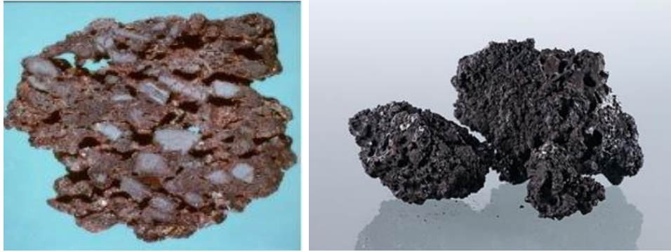
Şekil 3.5. Sinterleme sonrası elde edilen ürün
