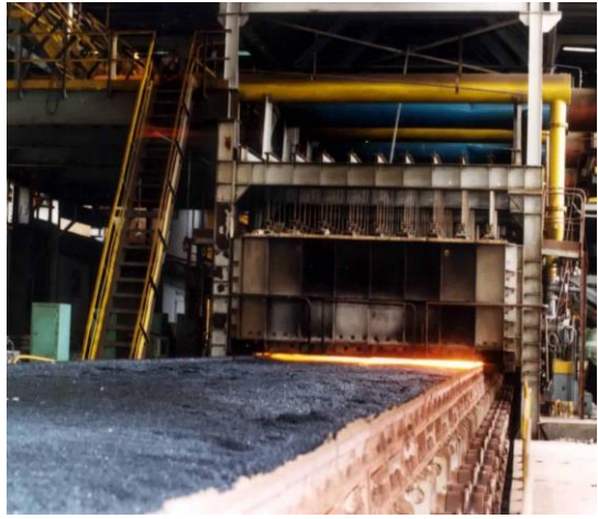
Şekil 3.4. Sinter harmanının sinter fırınına ilerlemesi ve yanma bölgesi
