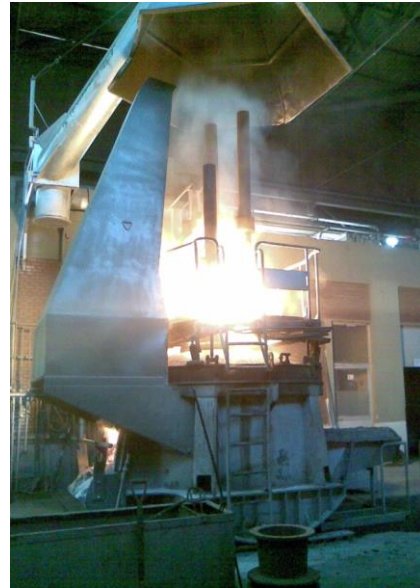
Şekil 7.14. Elektrik ark fırını
