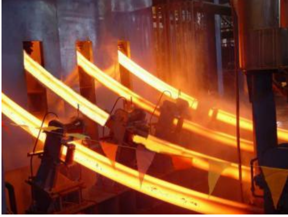
Şekil 10.5. Katılaşmış sürekli döküm ürünü
