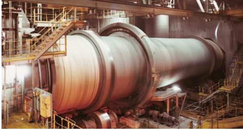
Şekil 3.11. Ham peletlerin pişirildiği fırın
