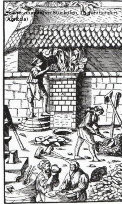
Şekil 1.3. 16.Yüzyılda demirci ocağında demir üretimi
