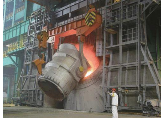
Şekil 7.8. Bazik oksijen fırınına sıvı metal (pik demiri) şarjı
