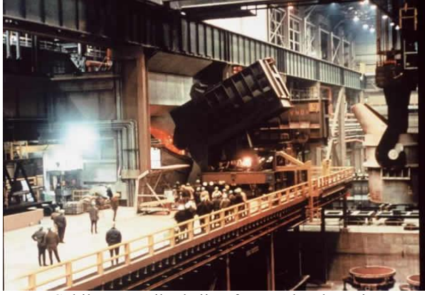
Şekil 7.7 Bazik oksijen fırınına hurda şarjı
