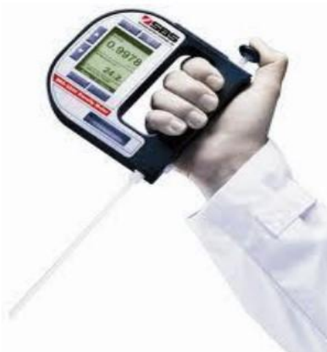
Şekil 26. Aşındırıcı konsantrasyonunun ölçülmesi, dijital yoğunluk ölçer
