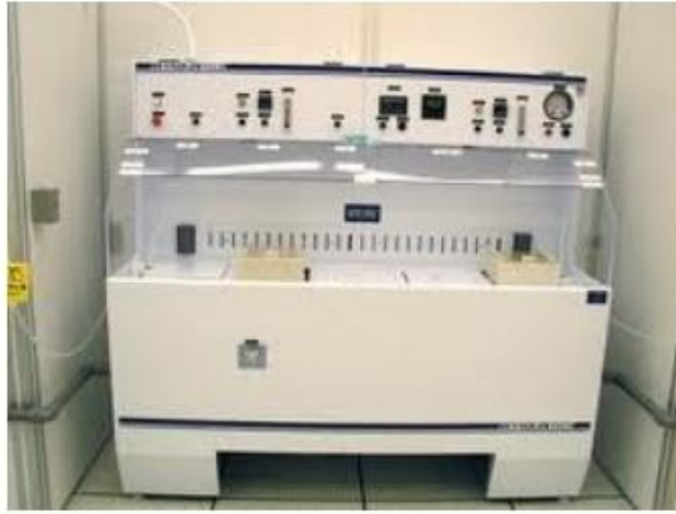
Şekil 13. 5 bölmeli ıslak dağlama masası
